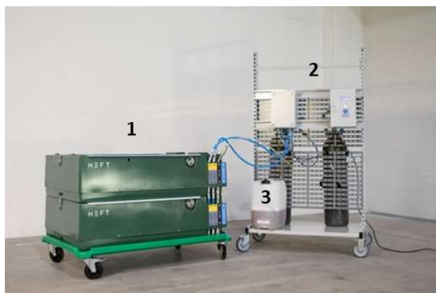
Figuur 2.10: Het materiaal bestaat uit een of meerdere boxen (1) met schuimgeneratoren, een stikstofunit (2) en schuimoplossing (3). Bron foto: RASA
