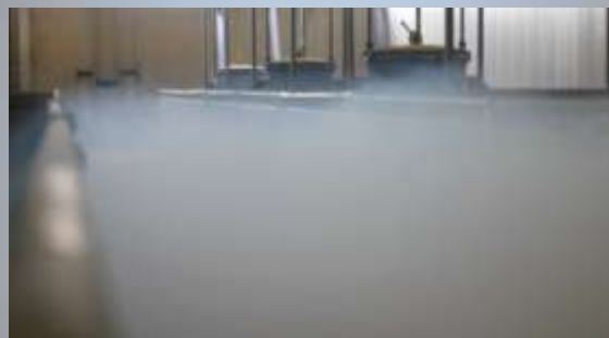
Figuur 11 De rookproef geeft het verwachte beeld bij kanaalventilatie
