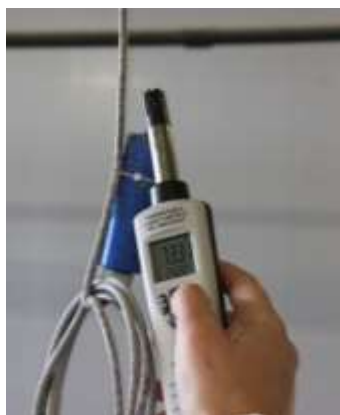
Figuur 10 Temperatuurmeting ter hoogte van voeler
