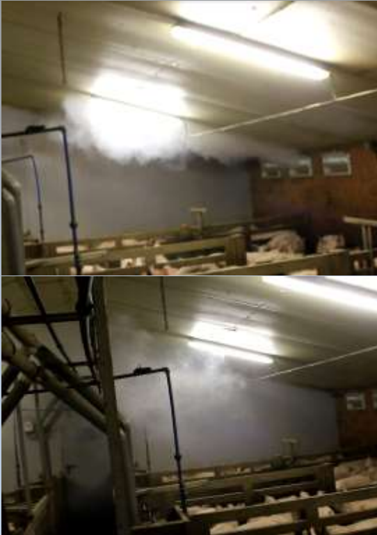
Figuur 10 De rookproef toont een verwacht patroon
