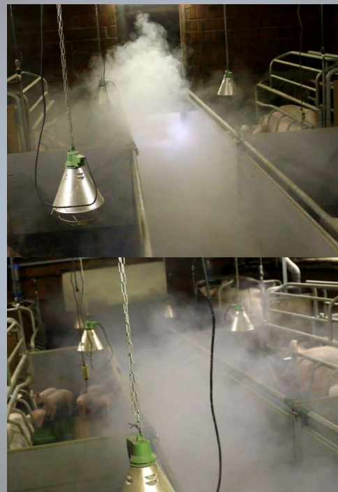
Figuur 11 De rookproef laat een normaal patroon zien
