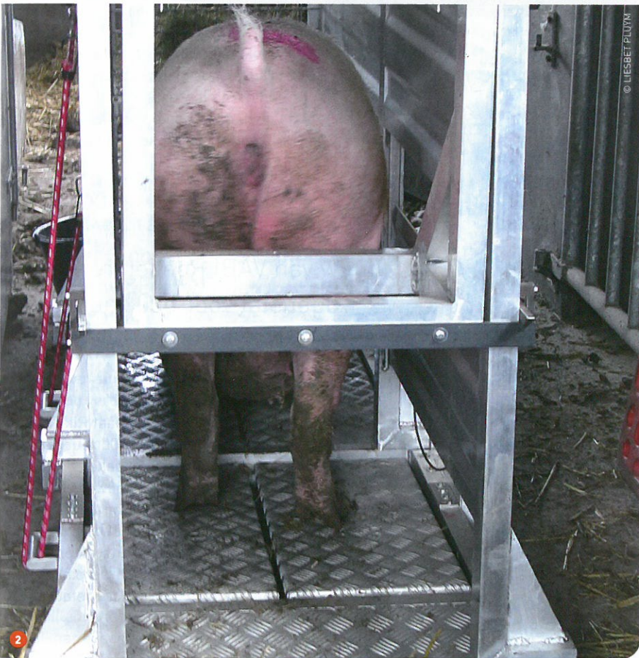
1 De SowSIS is demonteerbaar en transporteerbaar, praktisch voor gebruik op commerciële bedrijven en detecteert manke zeugen in stilstand. 2 Met de SowSIS kunnen zowel de gewichtsverdeling over de 4 poten als de verplaatsingen van elke poot geregistreerd worden.
